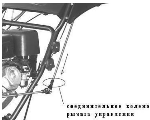
Рисунок 5. Установка соединительного колена рычага управления.
