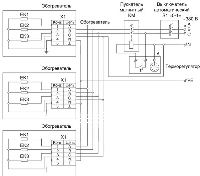
Рис. 2. Обогреватель ВИН-АР-3.0
